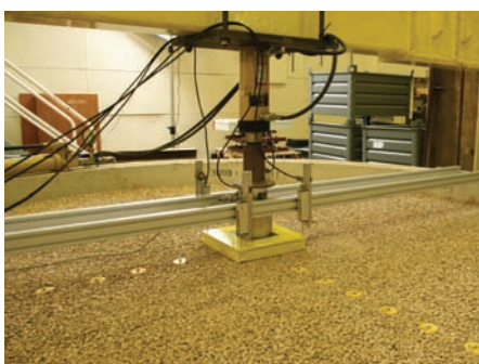
Thí nghiệm về khả năng sức chịu tải ở BRE chứng minh rằng lưới địa kỹ thuật TriAx giúp gia tăng khả năng phân bố tải trọng.
